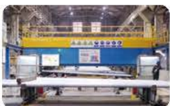
高噪音岗位配置隔音罩
