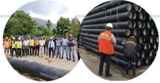
斯里兰卡HEMMATHAGAMA供水项目 K等级球墨铸铁供水管道和管配件(普通柔性接口以及双承口止脱接口Uni STD Ve) DN100-DN450 管道30公里、管件210吨
