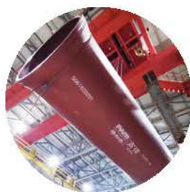
澳门完善新口岸区污水截流管 设计连建造承包工程 DN2000 K9级排水管及配套管件 (项目一期):管道4000吨, 管件2300吨
